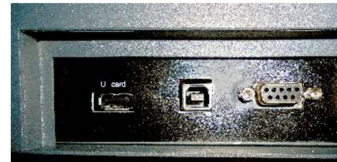
Conexión USB, COM y USB Pendrive
